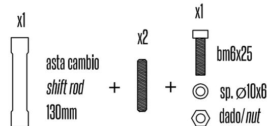
x1 asta cambio shift rod 130mm + x2 + x1 bm6x25 + sp. Ø10x6 dado/nut
